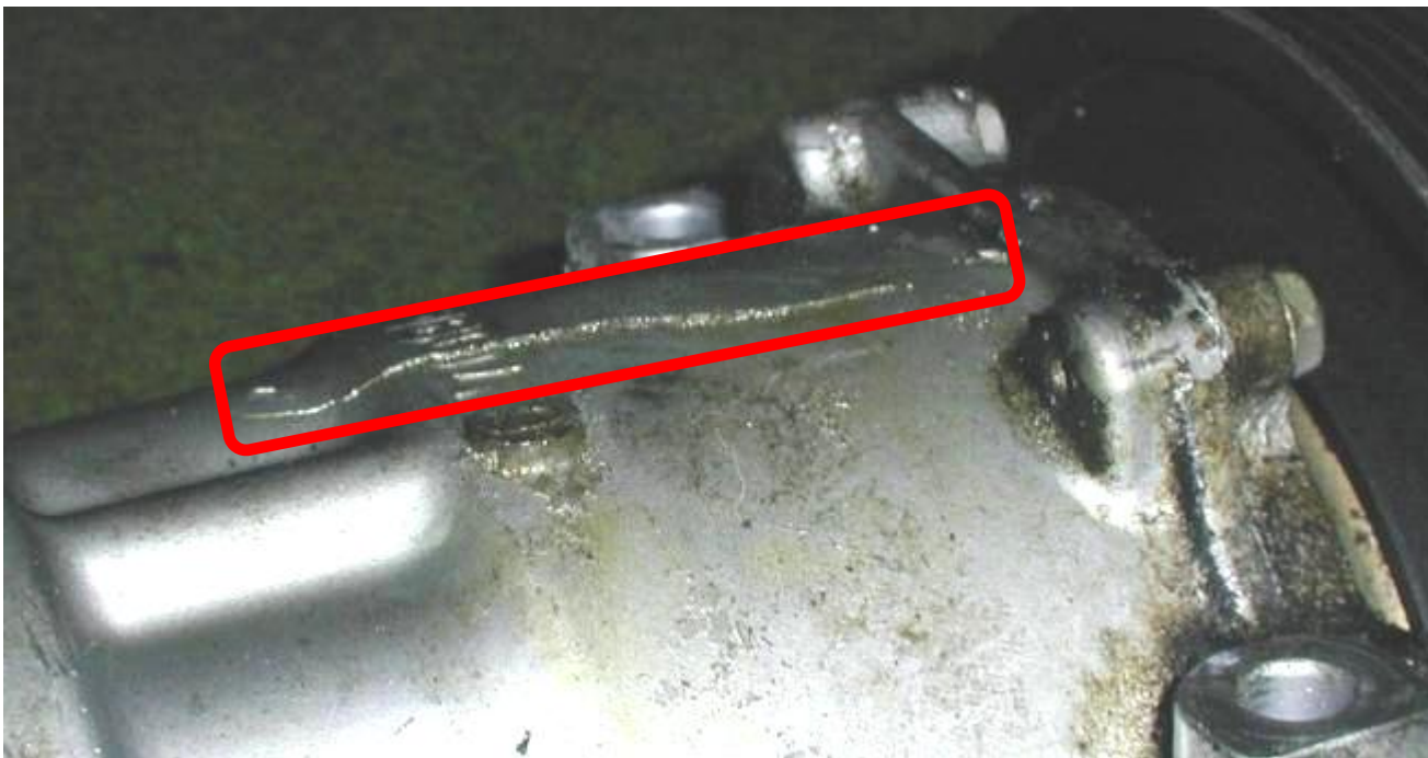
Prasknutý obal kompresora
